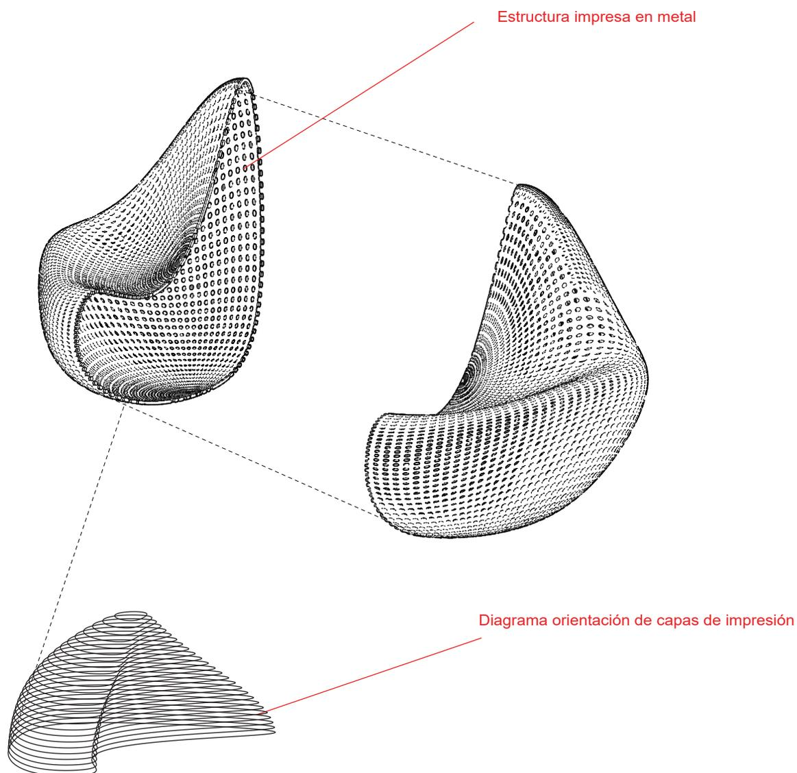
La familia de sillas “Muna” son impresas a gran escala, siendo impresas en 3D utilizando el método WAAM, el cual es un método de soldadura que obtiene las piezas a base de superponer capas de hilo metálicos. Para su fabricación fue necesario dividir la silla en dos partes iguales y acostar cada pieza para lograr una mejor impresión, finalmente se unen las dos partes utilizando la técnica de soldado .
